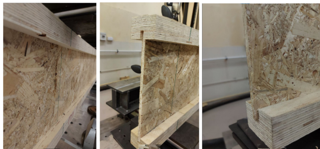
Рис. 6. Характер разрушения балки №8 – сдвиг ОСП-стенки относительно LVL-бруса, вертикальная трещина в ОСП полке в зоне приложения нагрузки
