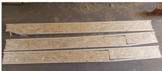
Рис. 5. Характер разрушения балок №9, 2, 5
